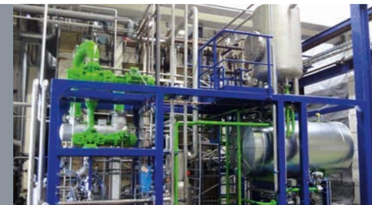
Bei der Vapour Phase Compact Anlage handelt es sich um eine neu entwickelte Anlagengeneration, bei der die Trocknungstechnologie mittels Kerosin eingesetzt wird. Dieses Verfahren hat sich in der Produktion von Leistungstransformatoren etabliert und wird auch bei der Herstellung anderer Hochspannungsbauteile eingesetzt.
